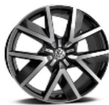
Jante aliaj Braça 9Jx20 Volkswagen R anvelope 285/45 R20 Dotare opțională, cod PJ3
