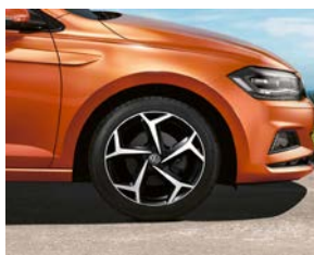
Jante aliaj „Bonneville” 7J x 17” negre Volkswagen R, anvelope 215/45 R17 Dotare opțională, cod PJA
